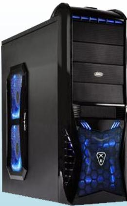
**صندوق الحاسوب :** هو صندوق حديدي أو من الألمونيوم وظيفته هي احتواء أهمّ الأجزاء الكهربائية والإلكترونية التي يتكوّن منها الحاسوب. ويقوم بحماية المكونات الداخلية من التأثيرات الخارجية: الأوساخ والأتربة والغبار والمياه.
